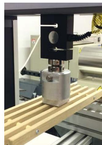
Test de charge des lames
